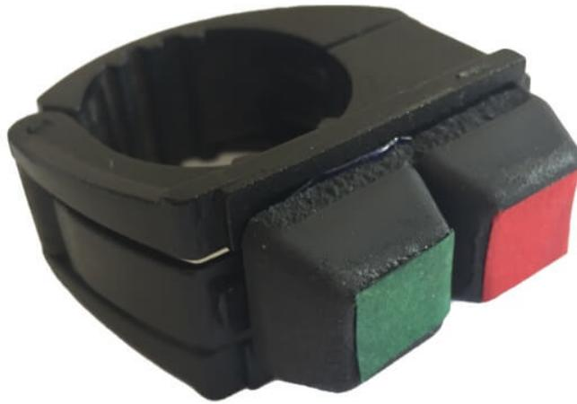
*Abbildung 15.* Klicker aus einer Lenkerhalterung und einem Radiergummi (1. Iteration)
